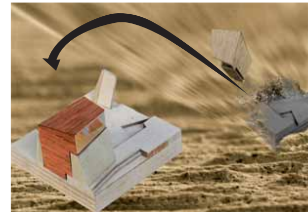
die Platte wird vom Absetzer überschüttet, die Holzkapsel wird auf die nächste Platte montiert
